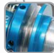
El muelle gira durante la extensión y compresión. La tuerca superior de tres piezas King permite una rotación natural del muelle sin torsiones
